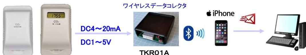
冷凍倉庫内やインキュベータなどに設置したトランスミッタで計測したデータを庫外にあるTKR01Aで記録し、Bluetoothで送信します。
