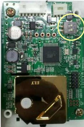
SW1: 電圧/電流出力、レンジ選択
