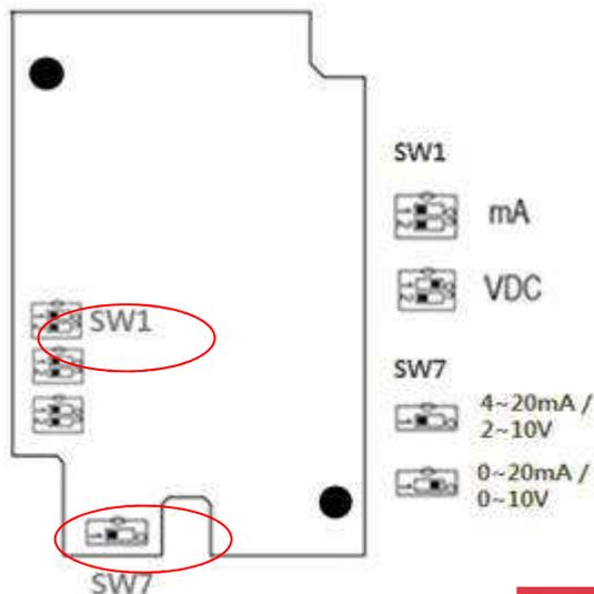
SW1で電流出力/電圧出力を選択します。
