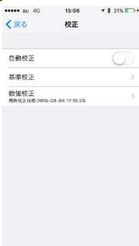
CO2センサは光源の温度による影響や経年劣化などで計測値がドリフトするため、校正する必要があります。本製品は3種類の校正方法を選択することができます。
