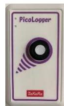
大気中のアンモニアガスを計測/記録します
